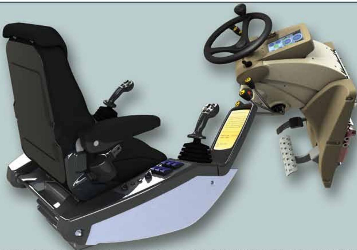
Gruppi colonna sterzo, ed assiemi integrati come braccioli multifunzionali completi di joystick, strumentazione, interruttori & cablaggio etc.. sia su disegno specifico cliente che standard.
